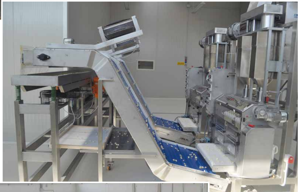
Particolare di un impianto automatico per la produzione di Orecchiette e formati tipici pugliesi, pastorizzati e confezionati in Atmosfera Modificata. Capacità produttiva 400 kg/h.
