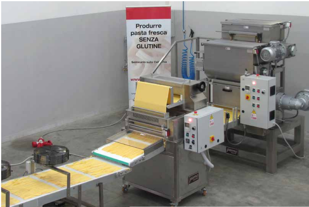
Linea automatica per la produzione di pasta fresca laminata, formato tagliatelle. Capacità produttiva 300 kg/h.
