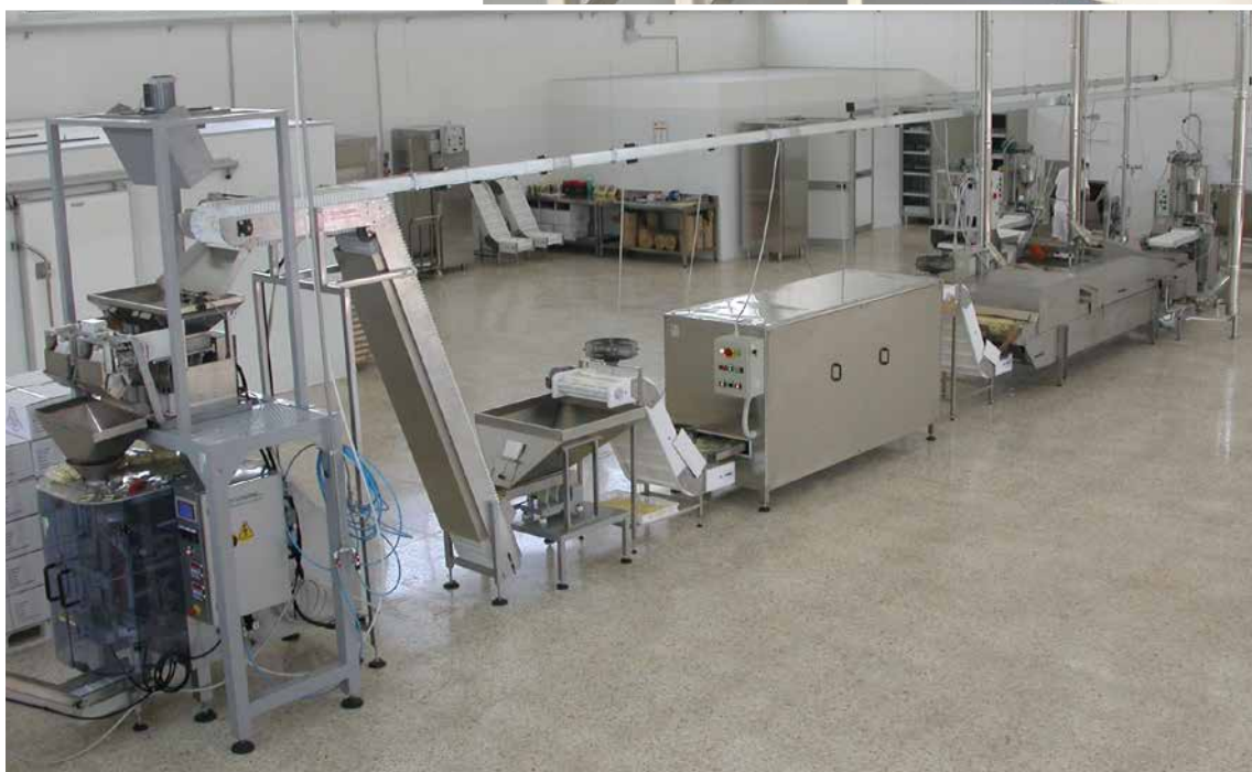
Impianto automatico per la produzione di pasta fresca senza Glutine nei formati tipici pugliesi, pastorizzata e confezionata in Atmosfera Modificata con Shel life 60 gg. Capacità produttiva 150 kg/h.
